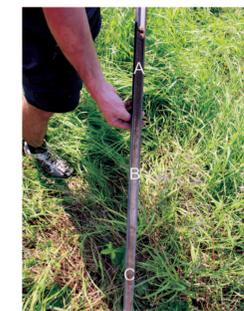
Bohrstock mit Bodenprobe
